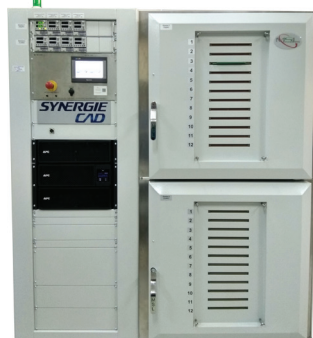
Электротермотренировка (ЭТТ): испытание микросхем при воздействии температуры
