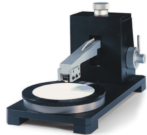
Измерение поверхностного сопротивления материалов
